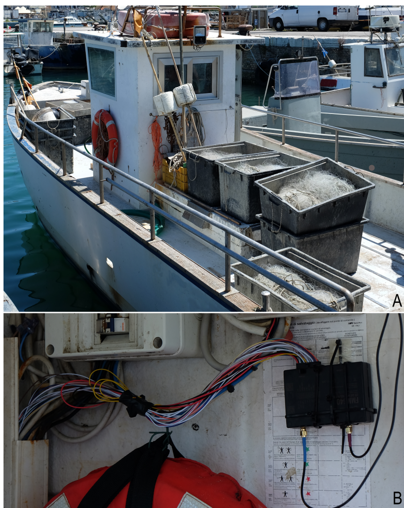
Figura 1.1: Un peschereccio per piccola pesca (a) a bordo del quale è installata una Teltonika FMM640 (b).
