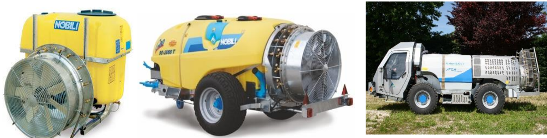
Figura 1-5 Macchine irroratrici di tipo portato, trainato e semovente
