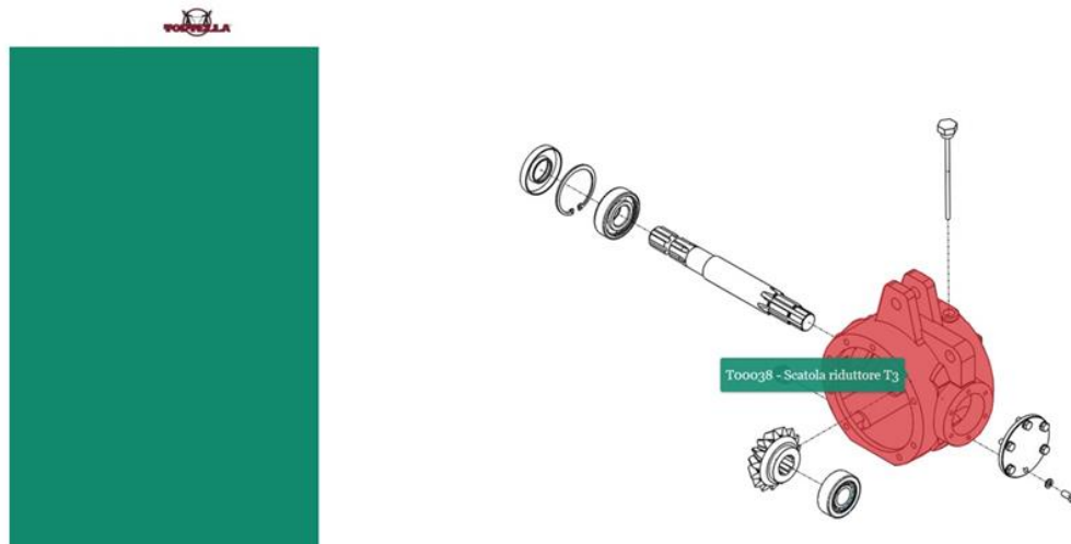
Figura 3.11 Esploso gruppo con evidenza di un componente non commerciale
