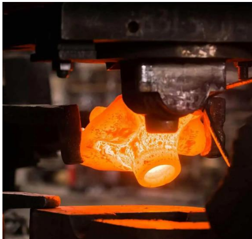
Figura 6 Operazione di forgiatura [7]
