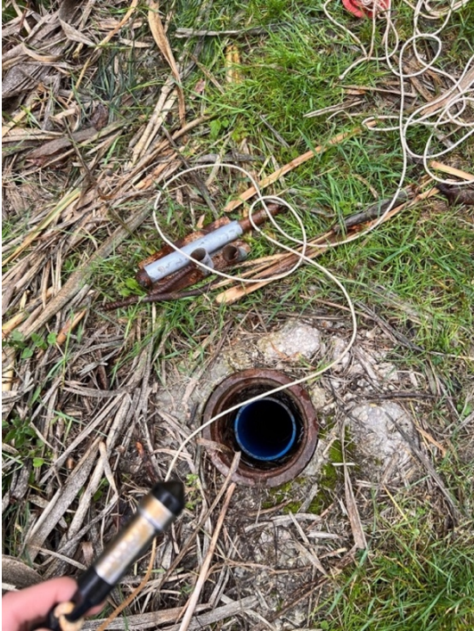
Fig. 3.1.1 4 Piezometro e sonda.
