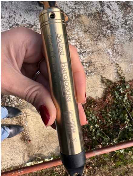
Fig.3.1.6 4 Solinst Barologger è uno strumento di misura utilizzato per registrare le variazioni della pressione barometrica. È progettato e prodotto da Solinst, un'azienda canadese specializzata in strumenti di monitoraggio ambientale.
