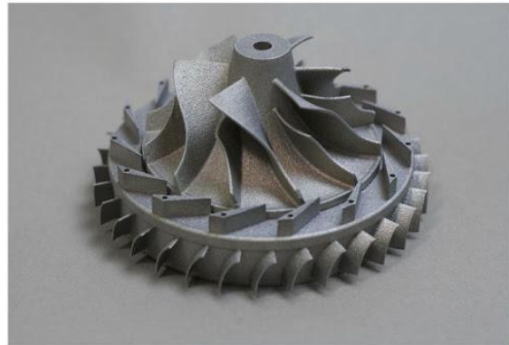
Figure 11 e 12 schema funzionamento lpbfd ed oggetto stampato
