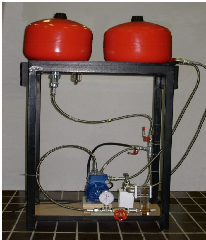
Fig. 2.1: Circuito idraulico di pompaggio del fluido
