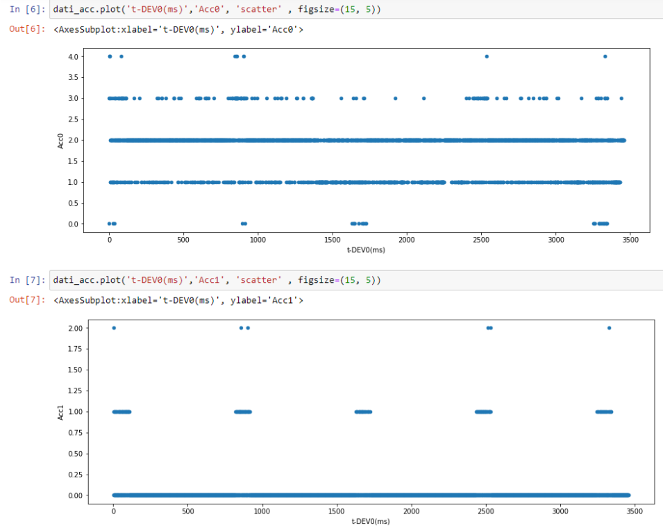
Figura 5.4. Campioni disponibili su info→scan_buffer , per entrambe le HAT, dopo l'attivazione della funzione mcc172_a_in_scan_read() , utilizzando la versione Real Time del sistema operativo Raspbian Lite
