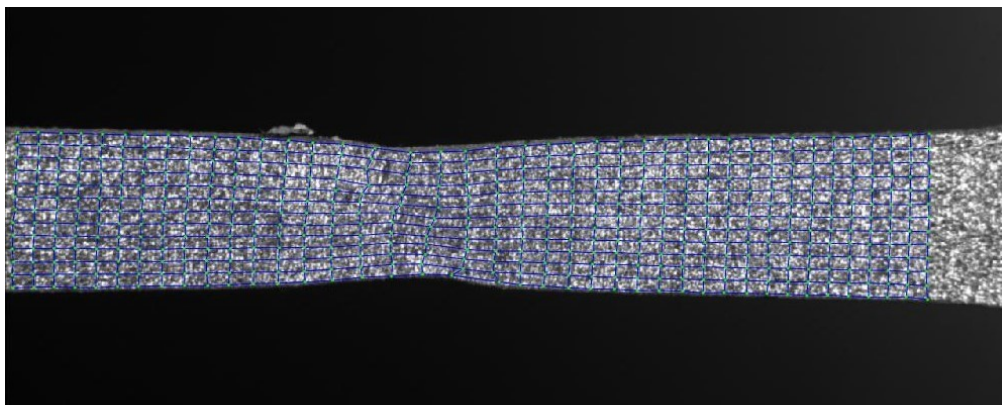
Figura 3-7 – Mappa del provino con strizione
