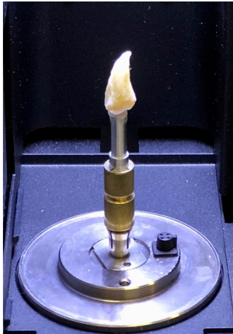
Figura 8: Campione posizionato sul supporto interno della \mu -CT.
