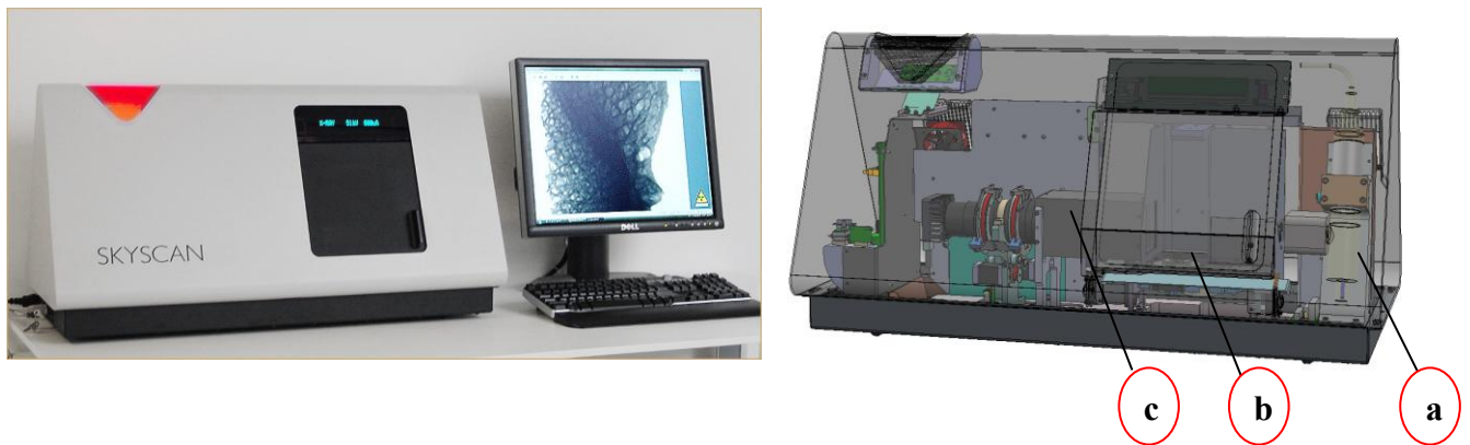
Figure 6, 7 a-c: Microtomografia BrukerSkyscan1174: a) sorgente di raggi X con micro focus; b) alloggiamento del campione; c) camera CCD.
