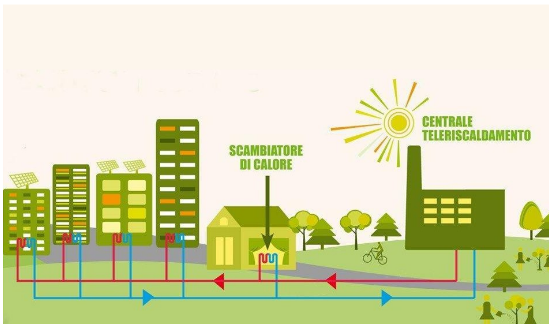
Figura 2-1: Rappresentazione di un sistema di teleriscaldamento
