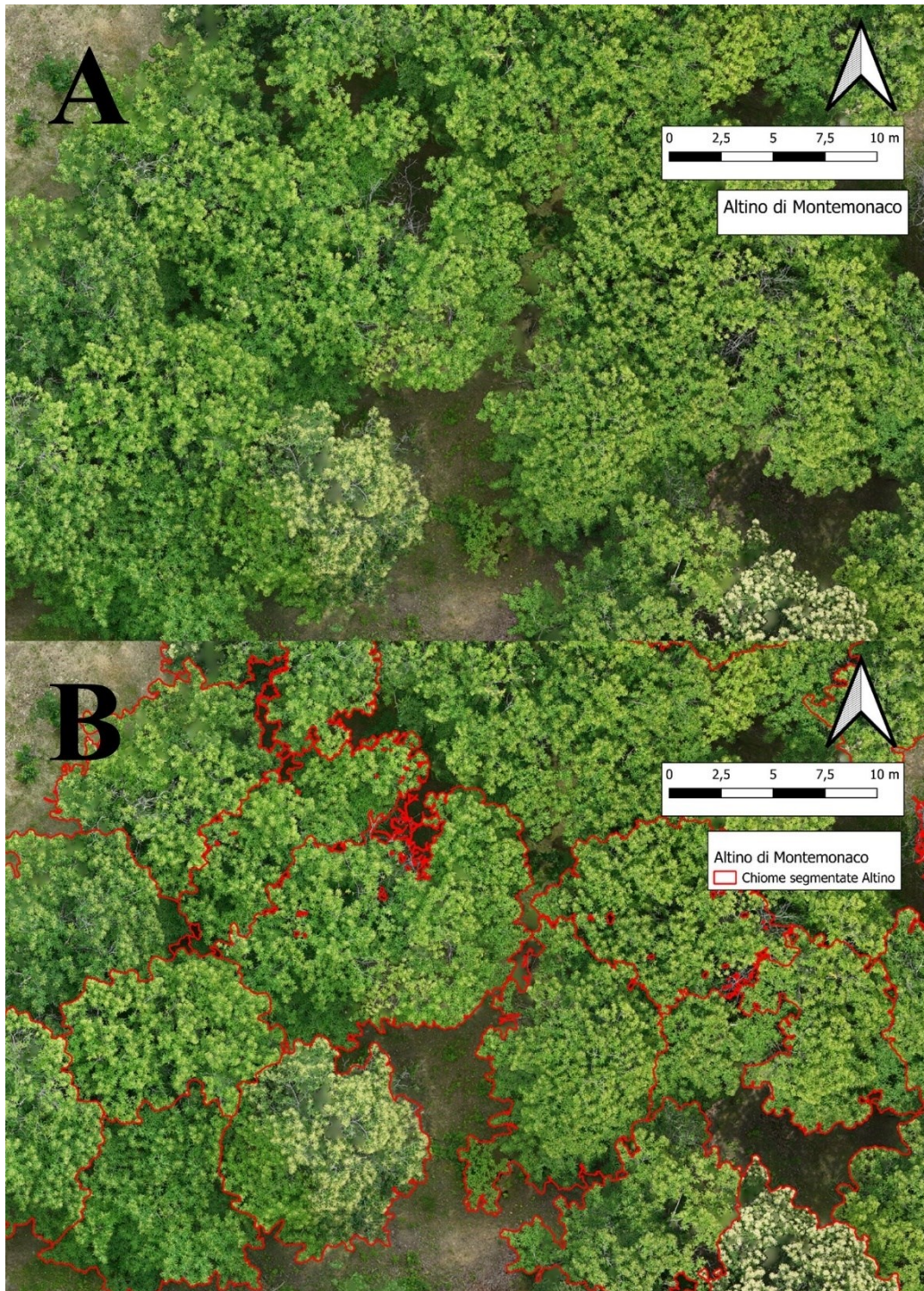
Figura 16. A) Estratto dell'ortofoto RGB del castagneto argomento di tesi; B) In rosso la segmentazione delle chiome degli alberi analizzati.
