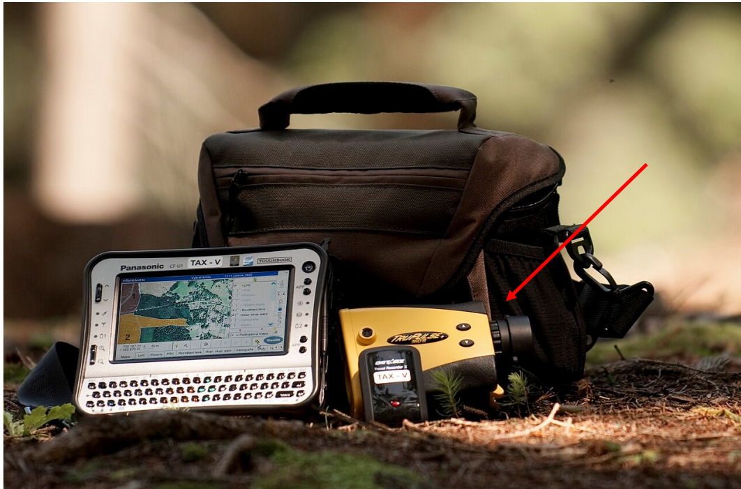
Figura 13. Dispositivi utilizzati in attività di mappatura forestale con FieldMap. Lo strumento segnalato in rosso è un Telemetro laser dotato di inclinometro e bussola, necessario per la misurazione delle distanze e degli angoli.
