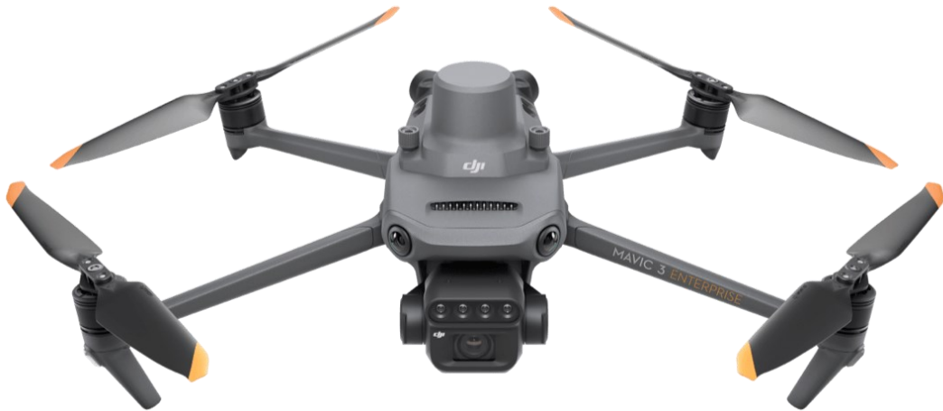
Figura 14. UAV DJI Mavic 3M con i sensori che acquisiscono le diverse bande (R, G, NIR e Red-Edge) ed il modulo RTK.
