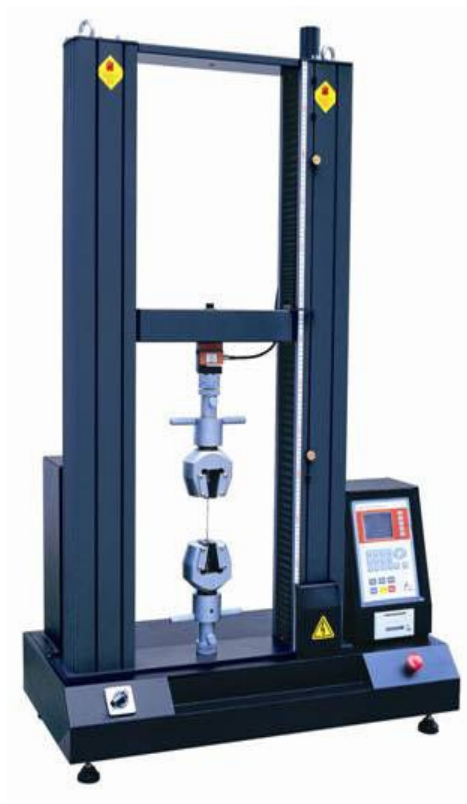
Figura 5. Macchina per prove di trazione mono assiali di nuova concezione
