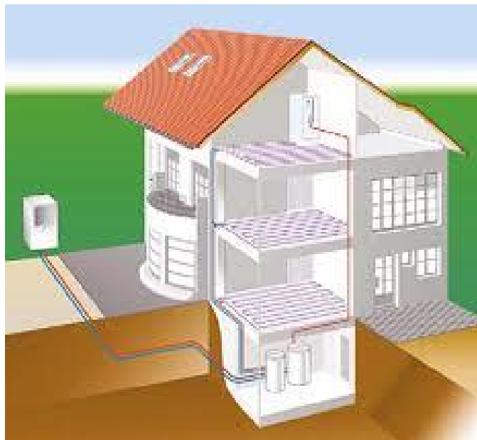
Figura 2.8 Impianto con pompa di calore aria-acqua [8]
