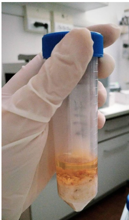
Figura 13. Provetta FALCON IPA free contenente il campione di filetto di M. barbatus dopo l'aggiunta di Sali e acetonitrile e dopo la centrifugazione del campione.
