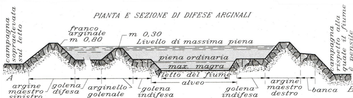
Fig. 67: Sezione schematizzata di un alveo fluviale, tratto dal testo "Sistemazione dei corsi d'acqua" [18, pag. 457].
