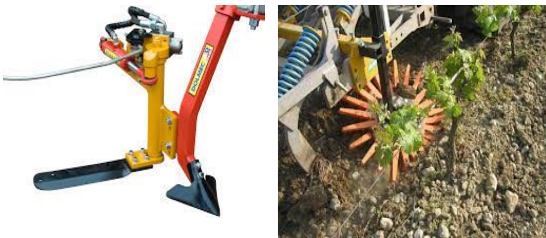
Figura 6 Esempi di macchine per la lavorazione meccanica interceppo
