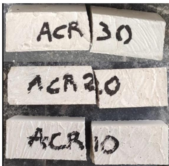
*Figura 54 - Meccanismi di rottura provini ACR*
