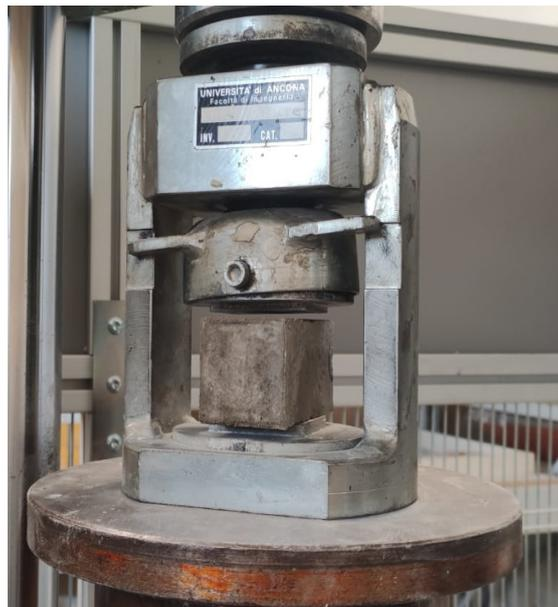
*Figura 39 - Prova a compressione provini  $4 \times 4 \times 16 \text{ cm}^3$*
