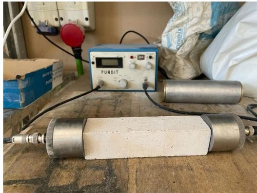
*Figura 40 - Prova di Pundit*
