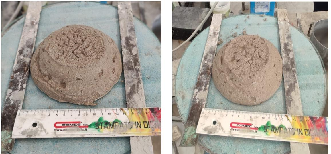
*Figura 46 - Prova di spandimento ACR\_20 (sx) e ACR\_30 (dx)*
