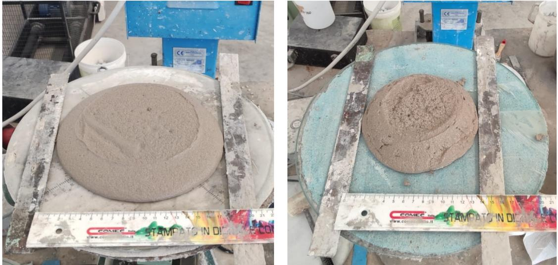
*Figura 45- Prova di spandimento SB\_30 (sx) e ACR\_10 (dx)*
