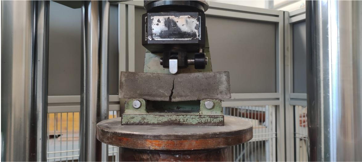
*Figura 37 - Prova a Flessione provini 4x4x16 cm<sup>3</sup>*
