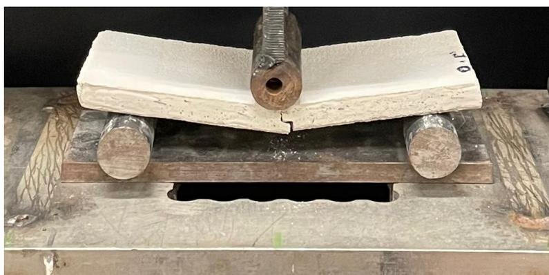
Figura 63 - Curva di forza – spostamento e rottura a flessione del provino RIF\_0
