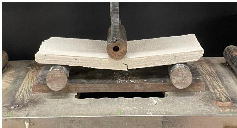
Figura 64 –Curva di forza - spostamento e rottura a flessione del provino SB\_10
