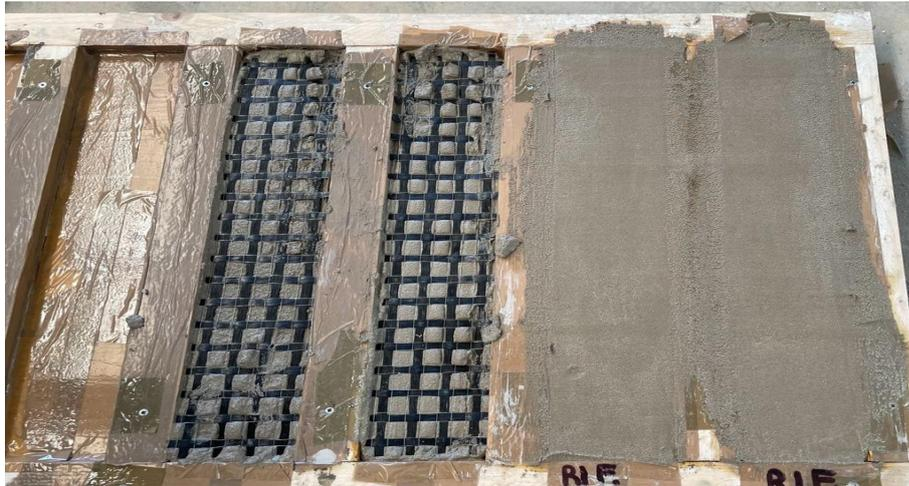
*Figura 28 - Applicazione delle fibre di basalto nei provini in esame*
