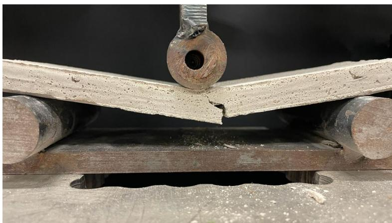
Figura 67 - Curva di forza – spostamento e rottura a flessione del provino ACR\_10
