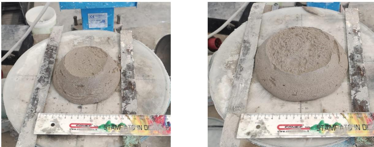
*Figura 44 - Prova di spandimento SB\_10 (sx) e SB\_20 (dx)*
