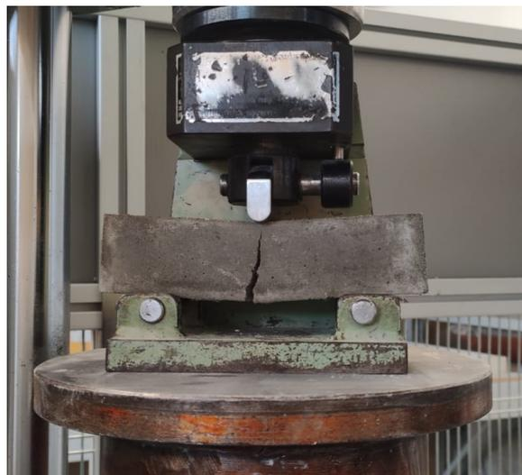
Figura 48 – Curva sforzo – spostamento a flessione e meccanismo di rottura provino MP\_100
