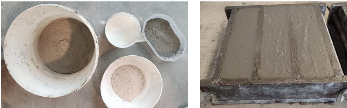
*Figura 30 - Preparazione provini 4x4x16 cm<sup>3</sup>*
