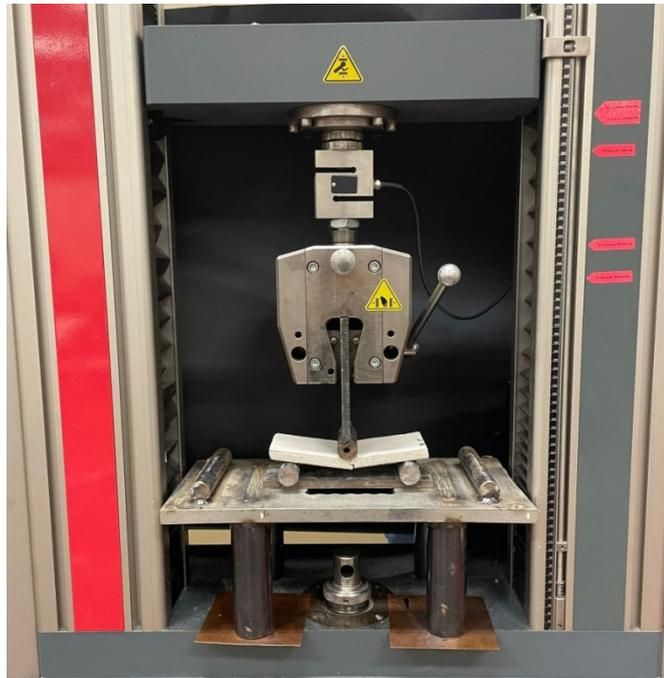
*Figura 38- Setup di prova a flessione provini 1x8x20 cm<sup>3</sup>*
