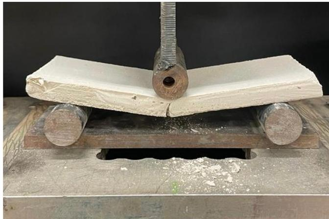
*Figura 69 - Curva di forza – spostamento e rottura a flessione del provino ACR\_30*
