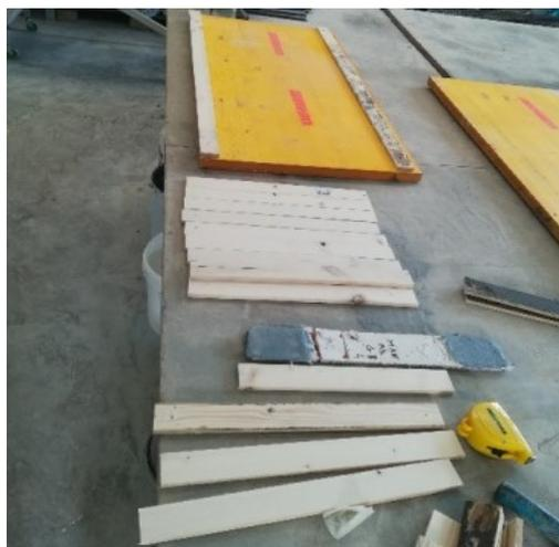
*Figura 27 - Predisposizione delle casseformi per i provini.*
