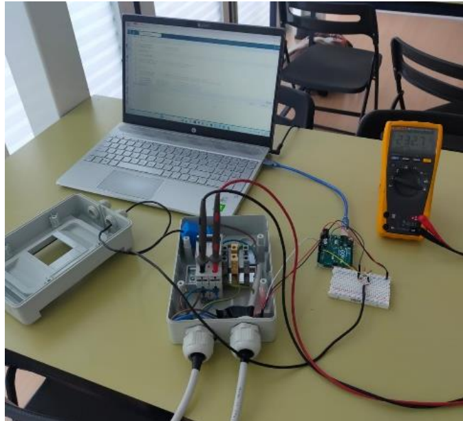
Figura 23. Misurazione della tensione nei cavi tramite il multimetro (a destra) e controllo dei valori nel monitor di Arduino
