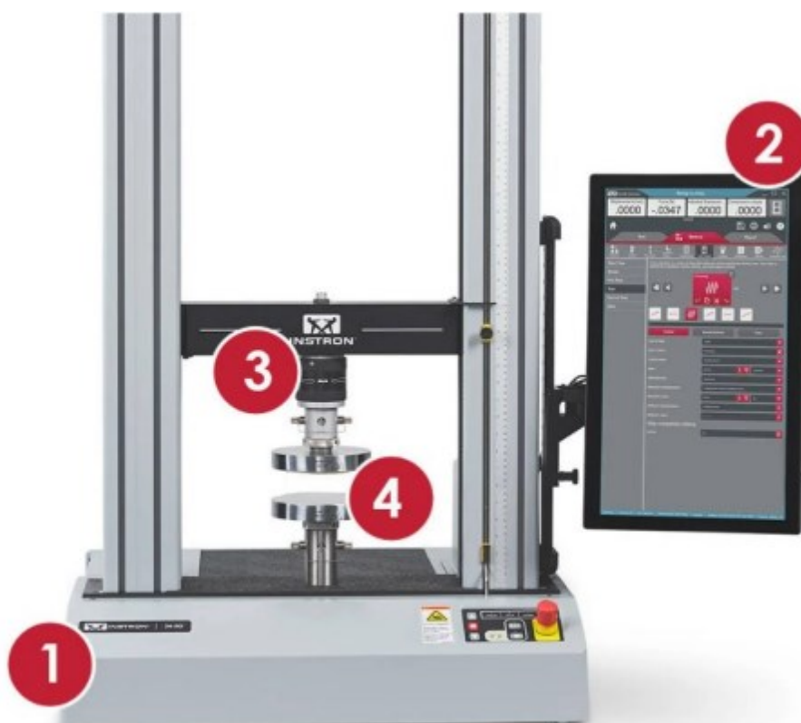
Figura 37 - Setup Instron ® 5969 per test di compressione: (1) telaio; (2) sistema di acquisizione; (3) celle di carico; (4) piastre di compressione
