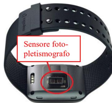
Figure 12: sensore foto-pletismografo
