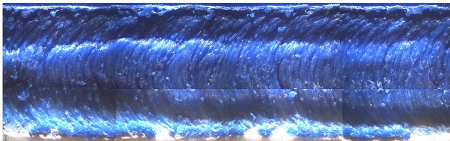
*Figura 46 – Fotografia allo stereomicroscopio della saldatura con parametri 1650-40-04 - prima passata*
