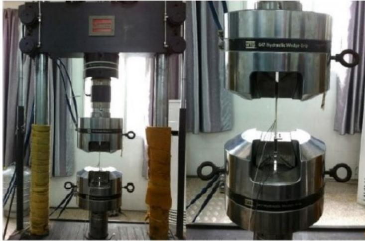
Figura 37 – Macchina universale MTS 810 configurata per la prova di trazione
