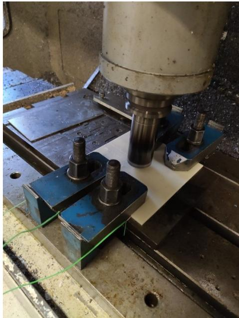
*Figura 35 – Operazione di FSW dei piastrini in ABS. Si possono osservare i serraggi dei piastrini e le termocoppie (fili verdi) usate per determinare la temperatura raggiunta in prossimità del cordone di saldatura*
