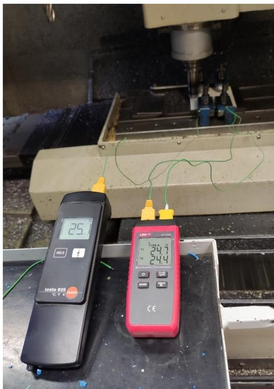
Figura 56 – Sensori di temperatura collegati alla piastra durante la saldatura
