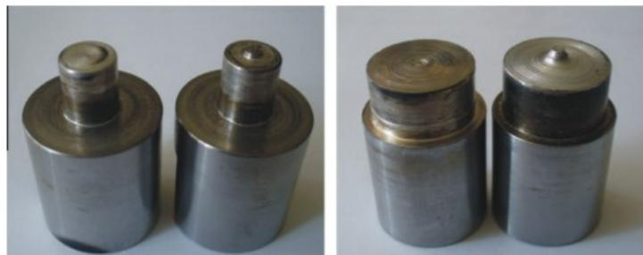
*Figura 18 – Due esempi di utensili con pin e pinless [20]*
