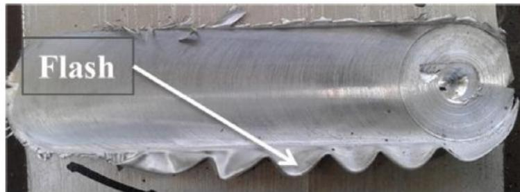
*Figura 23 – Bava formata ai lati del cordone di saldatura [14]*
