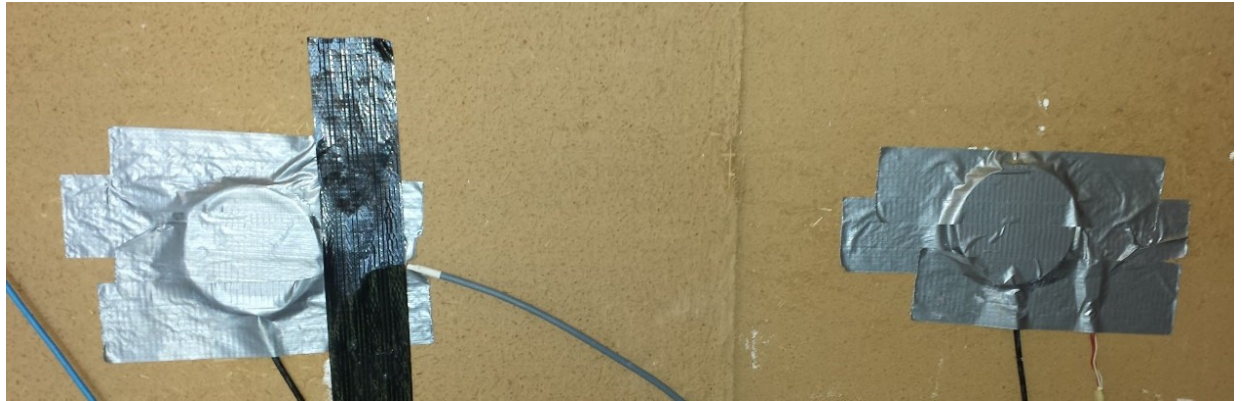
Figura 13 – Termoflussimetri e termoresistenze posizionati sulla terra cruda
