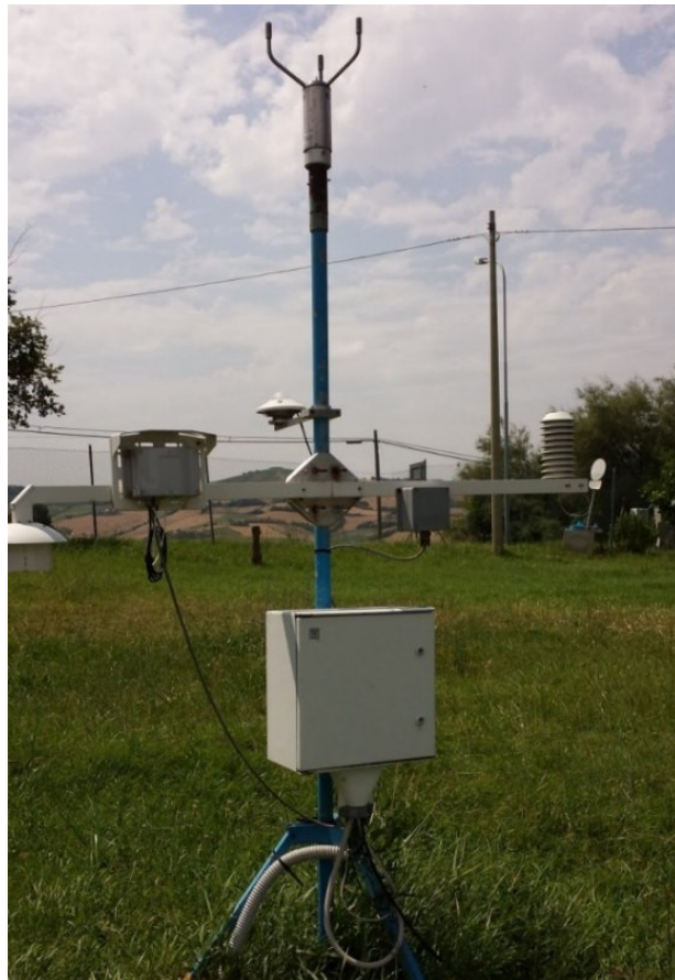
Figura 9 – Stazione meteo esterna
